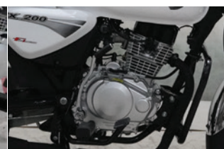
انجین ۲۰۰ سی‌سی دارای بالانس شفت
